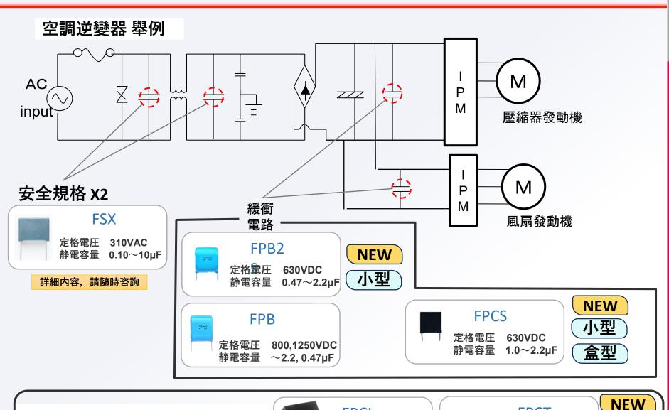
從電解電容替換薄膜電容 替換 大容量薄膜電容
